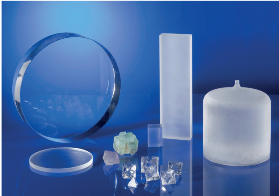
Natürliche und im Labor am Fraunhofer IISB hergestellte Kalziumfluorid-Kristalle für UV-Lichtbrechende Linsen. © Kurt Fuchs / Fraunhofer IISB
