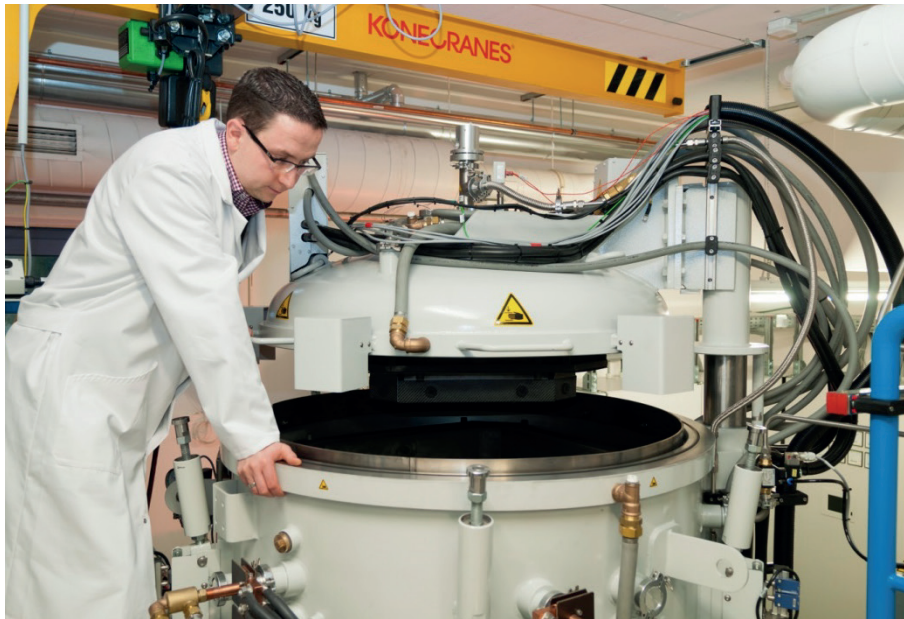
Die Anlagen zur Herstellung von multikristallinen Silizium-Blöcken für die Herstellung von Solarzellen sind etwa 3-4 m hoch. © Fraunhofer IISB
